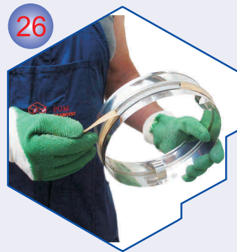
Sa inox prstena odlijepiti zaštitnu traku i isti postaviti u završnu ploču.
